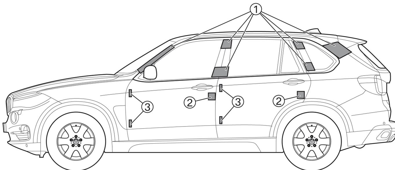
1. Le superfici contrassegnano le aree in cui il tetto può essere staccato. Per poter tagliare la carrozzeria sono necessarie moderne cesoie ad alte prestazioni. I dispositivi idraulici di tranciatura obsoleti possono non essere in grado di eseguire il compito.
