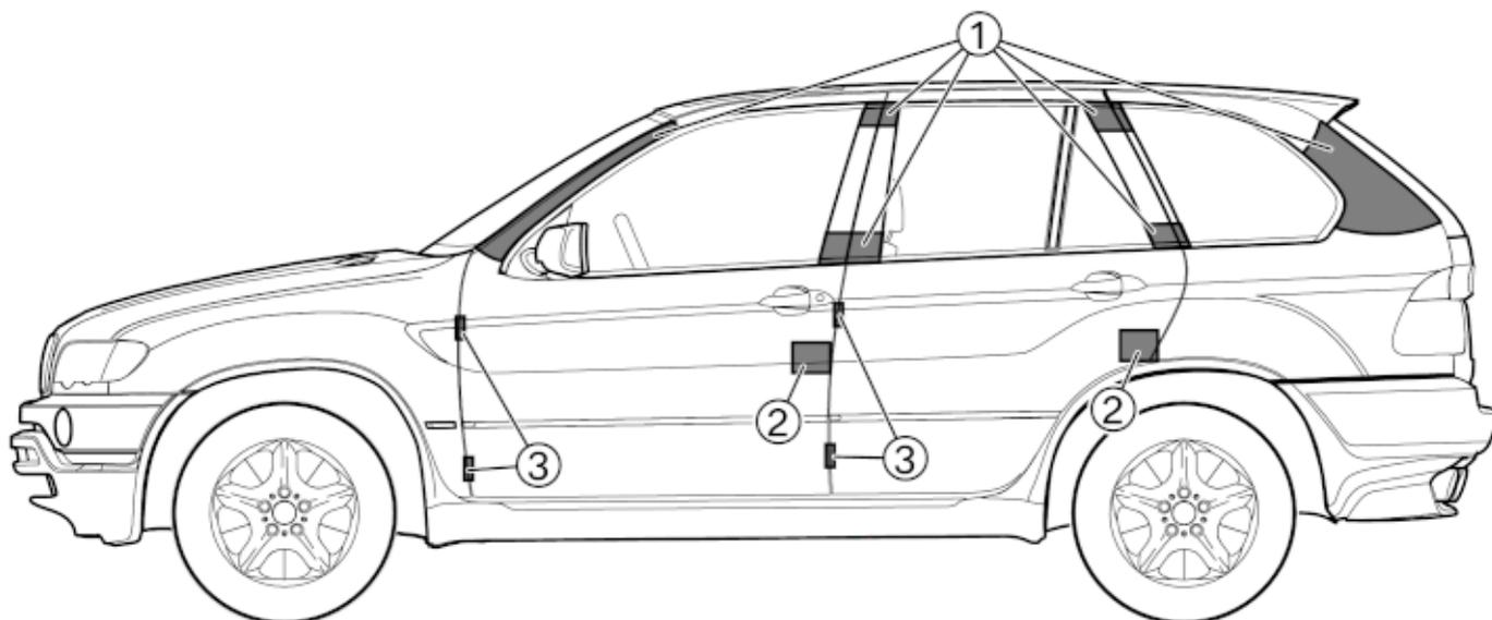
1. Le superfici contrassegnano le aree in cui il tetto può essere staccato. Per poter tagliare la carrozzeria sono necessarie moderne cesoie ad alte prestazioni. I dispositivi idraulici di tranciatura obsoleti possono non essere in grado di eseguire il compito.
