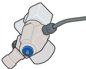
manueller Absperrhahn am Fuß des Flaschenventils.
