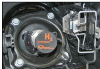
Bocchettone di rifornimento idrogeno (H 2 )
