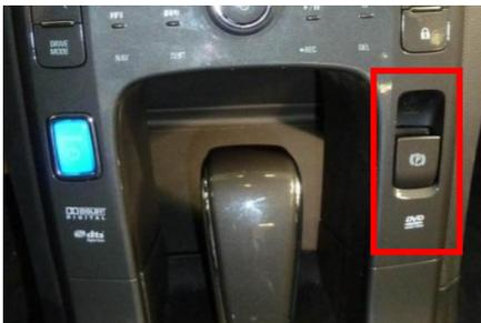
1. Azionare il freno di stazionamento elettrico
