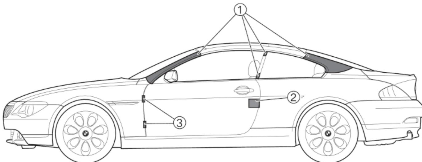
1. Le superfici contrassegnano le aree in cui il tetto può essere staccato. Per poter tagliare la carrozzeria sono necessarie moderne cesoie ad alte prestazioni. I dispositivi idraulici di tranciatura obsoleti possono non essere in grado di eseguire il compito.
