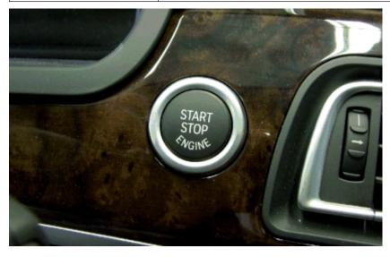
Se il motore è acceso o se i display sono attivi, sul pannello strumenti premere il tasto "START STOP ENGINE" per spegnere l'accensione.
