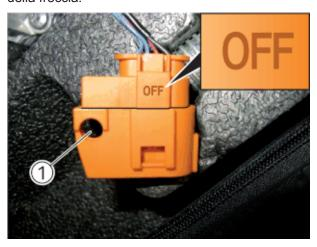
Il sistema ad alto voltaggio è disattivato se il foro (1) è completamente libero e se sul connettore la scritta "OFF" è pienamente visibile.
