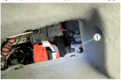
Allentare il dado e sfilare verso l'alto il cavo negativo della batteria (1). Coprire cavo negativo della batteria per escludere il contatto con il polo batteria.
