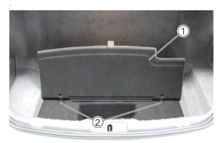
Aprire il cofano posteriore e ribaltare il rivestimento del fondo del bagagliaio (1). Allentare i dadi di plastica (2) ed estrarre il rivestimento del fondo del bagagliaio (1).
