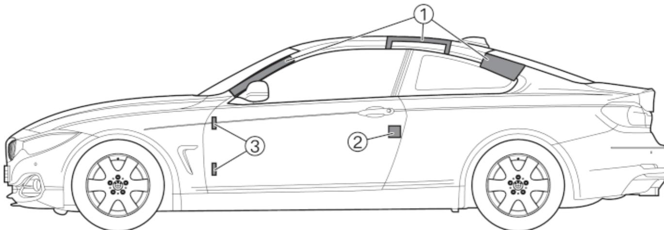
1. Le superfici contrassegnano le aree in cui il tetto può essere staccato. Per poter tagliare la carrozzeria sono necessarie moderne cesoie ad alte prestazioni. I dispositivi idraulici di tranciatura obsoleti possono non essere in grado di eseguire il compito.
