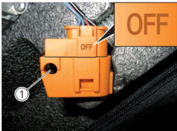
Il sistema ad alto voltaggio è disattivato se il foro (1) è completamente libero e se sul connettore la scritta "OFF" è pienamente visibile.
