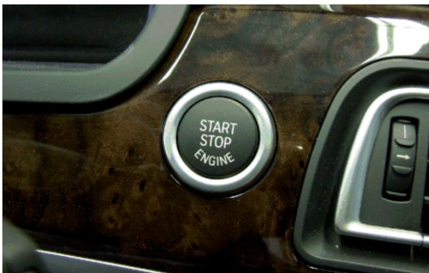
Se il motore è acceso o se i display sono attivi, sul pannello strumenti premere il tasto "START STOP ENGINE" per spegnere l'accensione.
